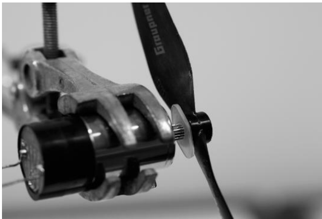
Fig. 1.8 : hélice montée sur la génératrice.
