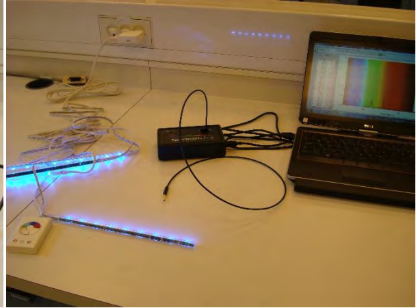
Mesures d'émission. Spectrophotomètre avec fibre optique et connexion à l'ordinateur avec le logiciel LoggerPro.
