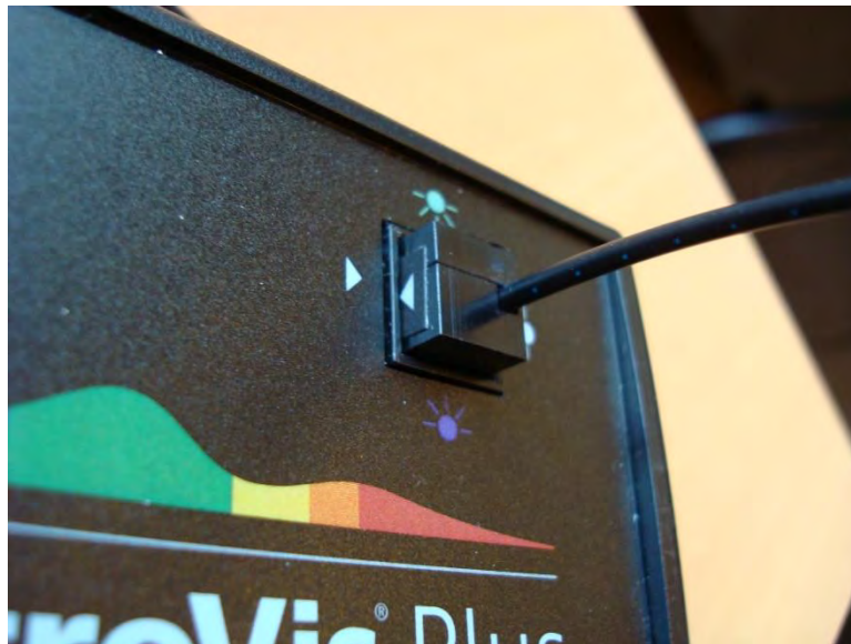
Figure 2.1b. Gros plan du montage de la fibre optique pour la mesure d'émission. Remarquer les flèches de correspondance pour le branchement.
