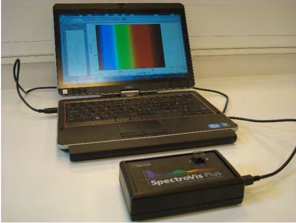
Mesures d'absorbance. Spectrophotomètre avec cuvette et connexion à l'ordinateur avec le logiciel LoggerPro.
